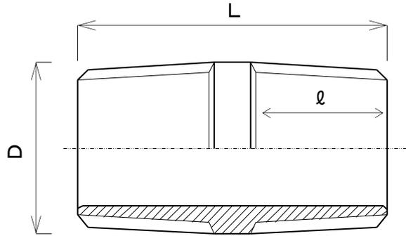
※ JIS G 3452 (配管用炭素鋼鋼管) 規格材を使用
